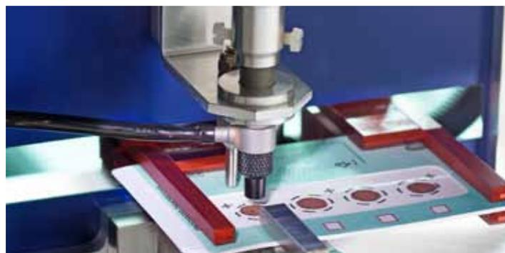
Нанесение внутреннего стандарта (ISA-модуль), система CAMAG DBS-MS
